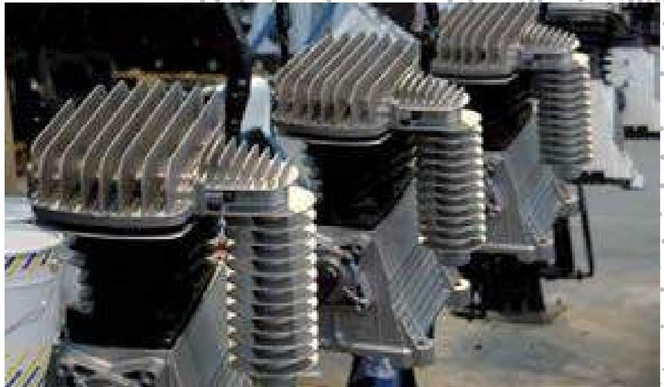
Têtes en aluminium moulé sous pression avec des larges ailettes pour un refroidissement meilleur
